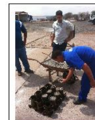
Moldagem corpo de prova F ci (1da) = 11 MPa
