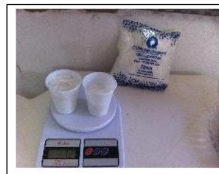
Fibra de vidro – Álcali resistente (12mm) ( 1,8 Kg/m 3 )
